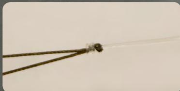
Die überstehenden Enden werden sauber abgetrennt und der Knoten mittels Zugtest geprüft.
