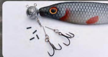
Einschrauben des Bleikopfes. Ein Sprengring stellt die Verbindung zwischen Tönchenwirbel und Schraubkopf her und die anderen Beiden die Verbindung zwischen Haken und Hakenfixierung.
