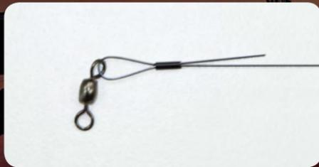
Wirbel zum Anbinden der Hauptschnur mit der Klemmhülse befestigen.
